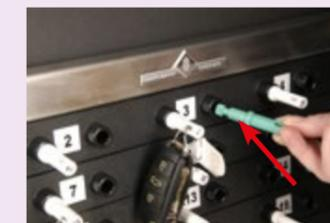
Jedem Mitarbeiter wird eine Bedienerstecker-Farbe zugeordnet. So kann jederzeit nachvollzogen werden, welcher Mitarbeiter gerade welchen Schlüssel in Gebrauch hat.
