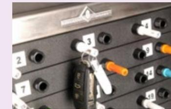
2 Um einen Schlüssel aus dem System zu entnehmen, muss dieser durch Einstecken eines Bedienersteckers entsperrt werden.
