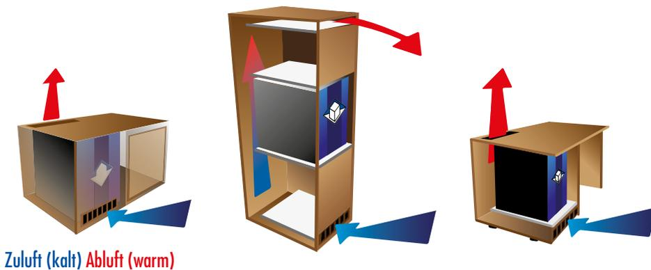
Außerdem sollten Minibars nicht in der Nähe von Heizungen und anderen Wärmequellen installiert und auch nicht einer direkten Sonneneinstrahlung ausgesetzt werden, da dies ebenfalls zu einem höheren Energieverbrauch führt.
