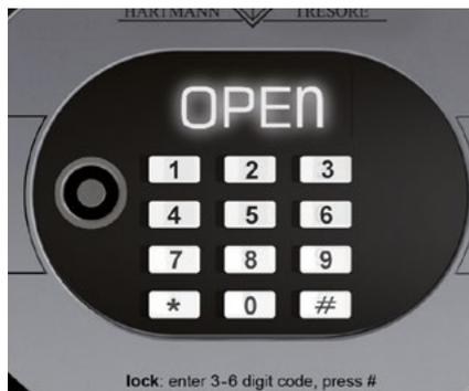
Elektronisches Tastenschloss und Design-Display mit weißen LEDs
